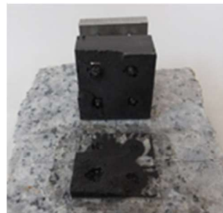
写真-3 はく離状況
