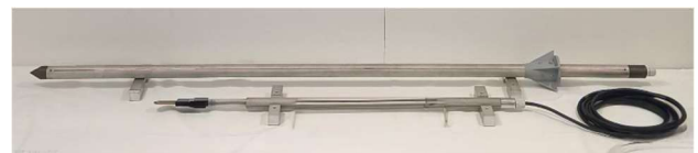
写真-1 傾斜センサプロブ（上） 土壌水分センサプロブ（下）
