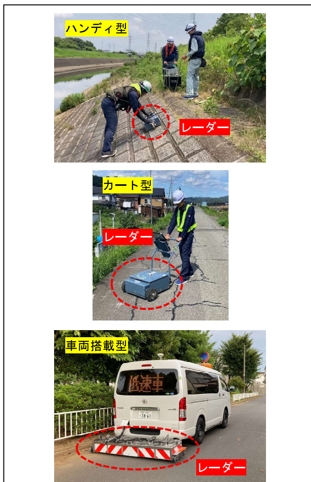
図-4 地中レーダー探査装置の例
