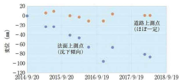
図-7 道路上測点と法面上測点の SBAS 解析変位 4)
