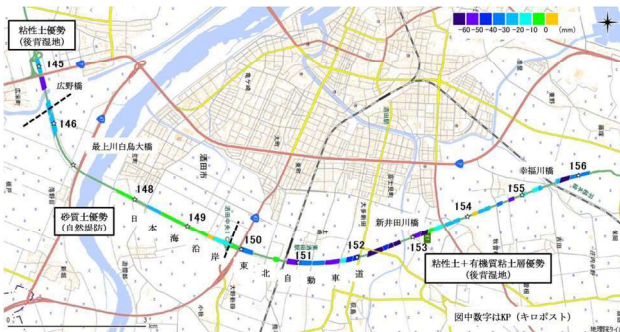
図-4 PS-InSAR 解析による道路盛土の沈下例 3)
